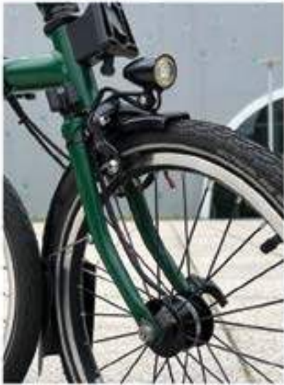
Kiley 的前燈以復古設計被翻新——現在也能使用燈電芯供電。
