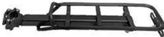
CD-27QR 座管貨架利用生成式 AI 減少 30% 的材料使用，同時維持耐用性。
