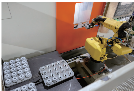
Shutter PrecisionのCNC旋盤に未加工のハブシェルを供給するロボット。
