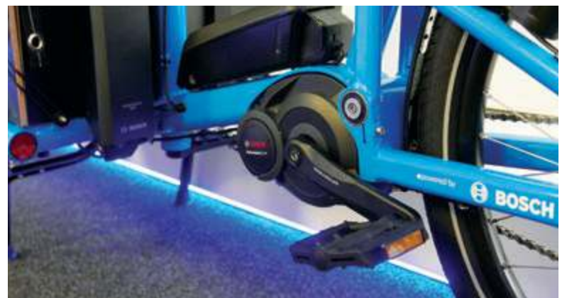
Reichweiten-Probleme bei E-Tourer? Nicht mit „Dual Battery“, dem neuen Bosch-Angebot mit doppelter Kapazität. Beide Akkus sind hier an den Rahmen montiert. Foto: JB
