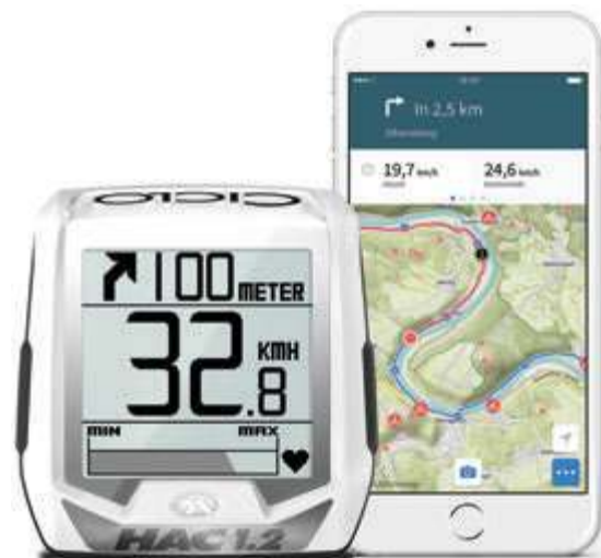
Ciclosports HAC 1 dient als zweites Display für Smartphones mit der Komoot-App.
