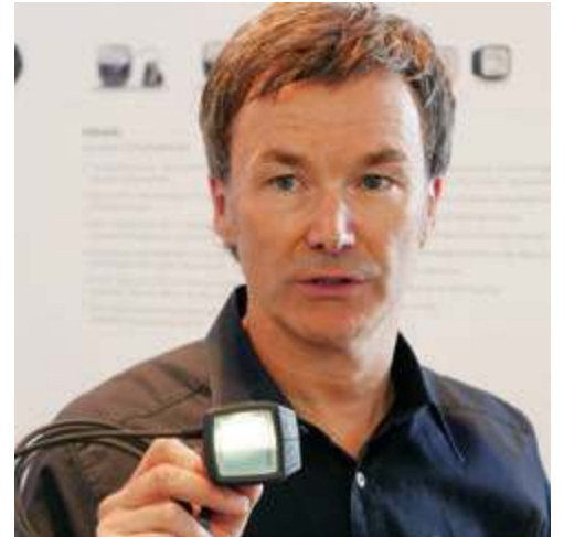
Das ist er: Der von Bosch eBike Systems Bereichsleiter Claus Fleischer gehaltene neue puristische E-Bike-Bordcomputer »Purion«. Er wird – links am Fahrradlenker angebracht – per Daumen gesteuert. Foto: JB
