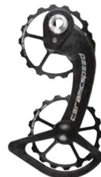
オーバーサイズの17歯ディレクタープリー（滑車）は摩擦を削減しエネルギー消費を減らすのでレースで使えばさらに一歩優位に立てる。プリーは低摩擦CeramicSpeedベアリング、カーボンファイバー/ポリアミド製エアロダイナミックケージ、チタン製ボルトで構成。シマノ10x、11x Di2およびメカニカルドライブレインと互換性があり重さ55.4g (1.9オンス)。
