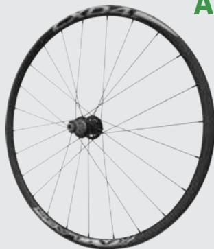
CXD4是專為碟刹公路車及CX越野公路車所設計的輪組。這也是市場上最新、成長最快速的車款。其搭配了等距中心的花鼓，使得兩邊鋼絲的張力平均相等。輪圈的內外寬度分別為19mm及24mm，搭配23mm的框高，最適合泥地的使用。搭配了TRS準無內胎系統，為使用無內胎系統已經做好準備。目前提供700c規格，可對應中鎖式或六孔碟盤鎖孔。
